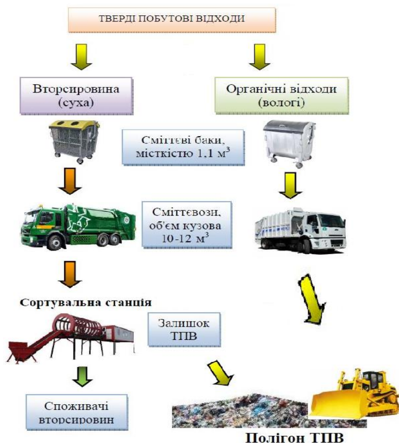
Рис. 2.1 Схема сортування ТПВ на 2 потоки
