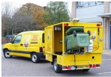
Фото. Обладнання для миття контейнерів на причепах
